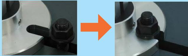
定盤T溝に計測スタンド下部の溝を合わせ、ナットを締めます。
